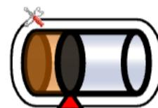
Assim como no sistema **gás** da Parte I, o pistão desliza sem atrito, e as paredes do cilindro e do pistão são condutoras de calor e possuem massas desprezíveis.
