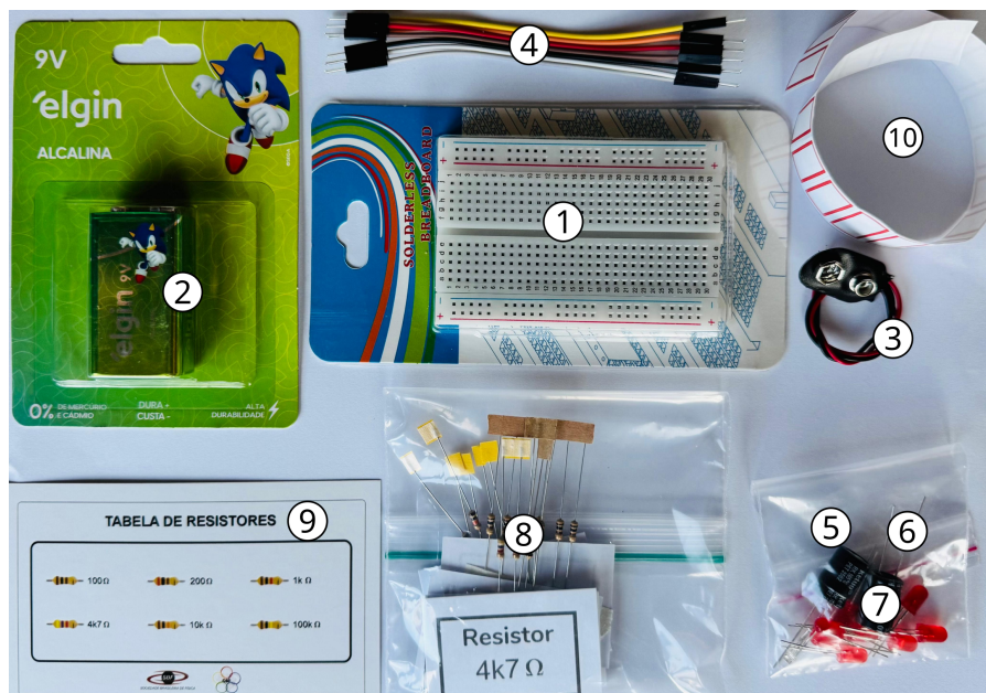
Figura 1: Material no kit. Os componentes identificados com números de 1 a 10 são descritos na Tabela 1. O segundo LED amarelo é sobressalente e está junto com os resistores.
