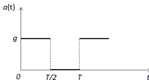
O valor  $T$  indicado é o período de oscilação do sistema massa-mola que se encontra dentro do elevador e  $g$  é a aceleração da gravidade. A posição de alongamento nulo da mola é  $x = 0$  e os coeficientes de atrito estático e cinético podem ser considerados iguais a  $\mu$ . Inicialmente o corpo se encontra em repouso na posição  $A_0 > \mu \frac{Mg}{k}$ .
