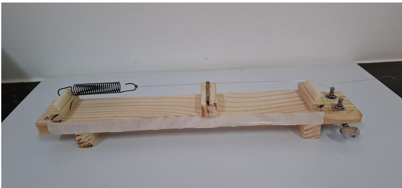
Figura 3: Esquema de montagem da corda associada à mola.
